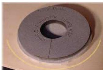
(5) Reparaturteil 3/8" (9,5 mm) größer als die Schablone schneiden. Mit Heißkleber verbinden.
