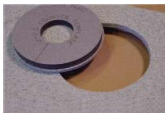
(8) Einsatz auf Bündigkeit mit Oberfläche prüfen und anschließend verkleben
